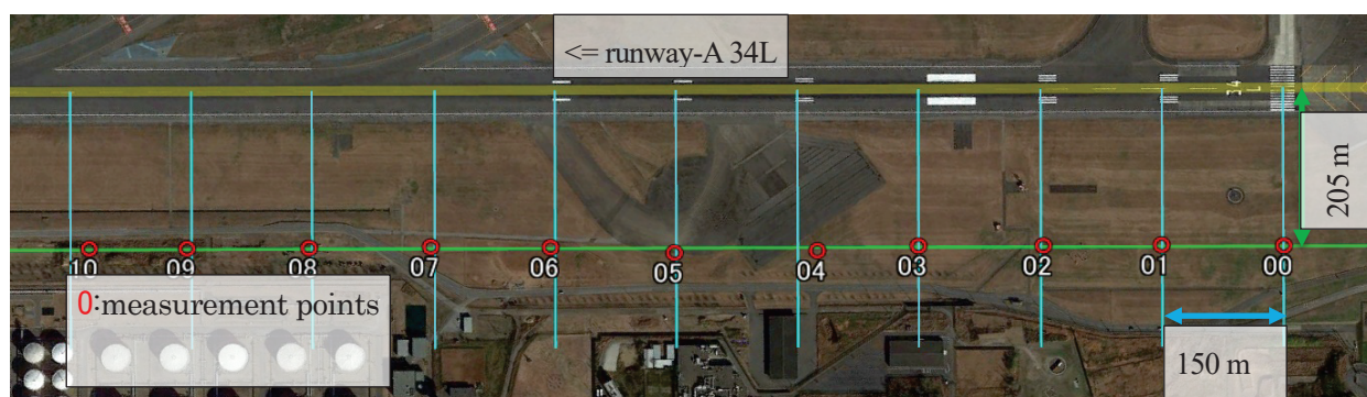
図3. 成田空港での速度の正味推力影響調査での騒音計配置
