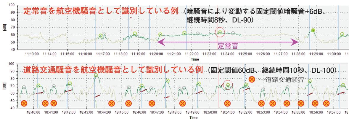
図-4 妨害音を誤って航空機騒音と識別している例（○印が航空機騒音として識別）
