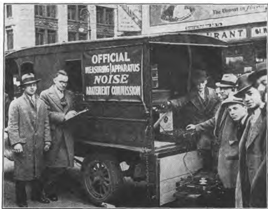
図2－1929年のニューヨーク市で「騒音」の調査に使用されたトラックと機器。トラックの側面の掲示には「公式測定装置；騒音対策委員会」とある。；“noise meter”と呼ばれていた当時の騒音計の重量は、電池と合わせて25kgを超えていた。
