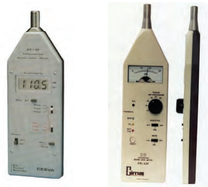
図16 - 1980年代終わりからの積分平均型騒音計。左：Cesva SC-10（スペイン製）。右：Cirrus 2.22（英国製）。SC-10型はA特性騒音レベルを測定するだけであった。2.22型はA特性、C特性、或いは時間平均した騒音レベルまたは騒音暴露レベルとしての、平均的に重み付けした騒音レベルを測定した。SC-10はデジタル式表示目盛りである。2.22型の表示盤は、等間隔にデシベルで刻んだ目盛りである。機器の厚みは単三乾電池の直径で決まった。マイクロホンとプリアンプは比較的、先細の機器本体に接近している。
