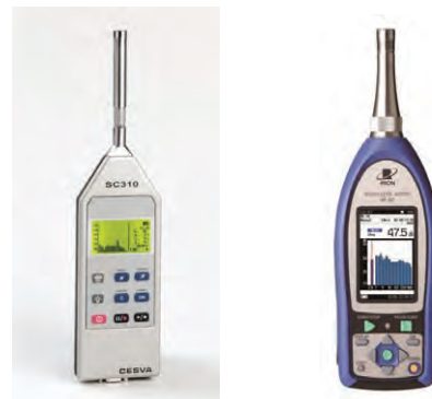
図23 多機能のクラス1騒音計の近代的なデザイン。Cesva社のSC310型(スペインのバルセロナ、左側)。Rion社のNL-62型(日本の東京、右側)。
