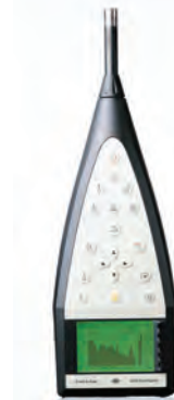
図19 - 1990年代に導入されたB&Kの多機能モデルでクラス1の騒音計であるモデル2260である。長い先細型の本体デザインが、機器本体からマイクロホンへの音の反射の影響を最小限にし、国際的な性能基準の指向性の要件に適合するのを助ける。直径13mmのコンデンサマイクロホンとプリアンプ。画面に1/3オクターブバンド音圧レベルを周波数の重み付けあり、又は無しで表示できる。
