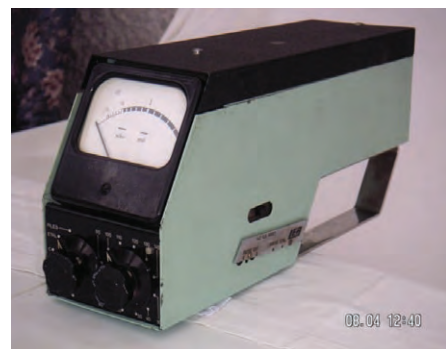
図10－1960年代に導入された、フランスのLEAによるS.S.T.1型騒音計。ハンドルを持って機器を支え、表示盤は観察者側にして、騒音源へと向けて使用した。マイクロホンはデシベル表示の騒音レベル表示盤の反対側のケースに入っていた。表示盤上に対数的に目盛りが配置された。
