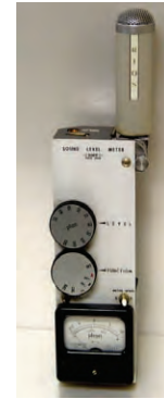
図 12 ー周波数に重み付けし、ホンで表す騒音レベル測定のために、1960 年代から使用されたりオン NA-07 型騒音計（日本製）。後にデシベル表示で騒音レベルを示すように改良された。表示装置の上のトグルスイッチで F 又は S の時間の重み付けを選択する。
