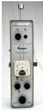
図 11 ー設計はオランダの Peekel 社だが、1960 年代に英国の Advance 社が SPM1 型として包装し販売した。周波数の重み付けはされていない。オクターブバンド音圧レベルを測定するだけであった。本体から短く棒を伸ばした先にマイクロホンが据えられ、使用しない時は本体の中にしまい込んだ。本体左側上部近くの「マイクロホン」の単語の上のボタンを押すと、マイクロホンを伸ばすためのばねが解放された。表示盤上に対数的に目盛りが配置された。
