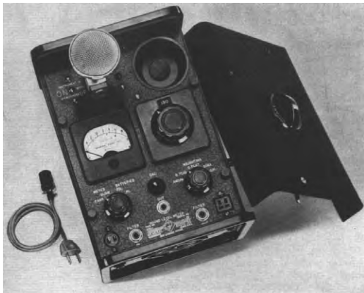
図5 - 1950年代初期に General Radio Company (USA) が導入した、1551A型携帯型小型騒音計である。目盛りの間隔はデシベルである。
