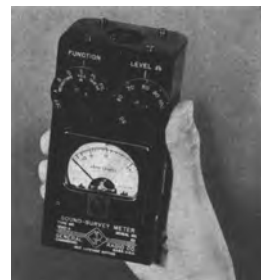
図7 - 1950年代半ばに導入されたGR1555A型の、当時は“sound survey meter”と呼ばれていた騒音計。インジケータのダイヤルに対数的に配置された印は、周波数に重み付けした騒音レベル (デシベルで表示) を表すが、解像度を変えられる。
