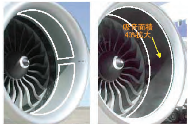
図4 従来型吸気口（左）と改良型吸気口（右）
