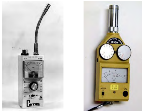
図15－1970年代からのクラス2騒音計。Cirrus 2.21（英国）とRion NA-09（日本）。両方ともデシベル表示で周波数に重み付けした騒音レベルを表示し、目盛りは対数的に配置されていた。FかSの時間の重み付けが使用できる。Cirrus 2.21は本体上部左側にくぼみがあり、細長い管の先についたマイクロホンが収納できるようになっていた。くぼみにはスピーカがあり、音圧信号を出して音響感度のチェックに使用できた。多くの顧客は音響校正器を購入したがらなかったために備え付けたものである。
