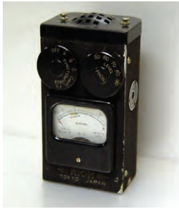
図8－1950年代に導入されたりオンN1101型騒音計。1942年のドイツの国家規格に示された要件のために、表示盤は周波数に重み付けした騒音レベル（ホンで表示）を表す。
