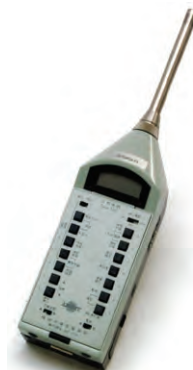
図18 B&Kの多機能型で1980年代のクラス1騒音計である2231モデルである。直径13mmのマイクロホンとプリアンプが、先細の機器本体から離して据え付けられている。選択した内容の騒音レベルがデジタル表示される。装置は時間平均した騒音レベル、FかSの時間に重み付けした騒音レベル、時間に重み付けした騒音レベルの、一定時間内の最大レベル、そして騒音暴露レベルを測定し、すべてAかCかフラットの周波数の重み付けが選択できる。
