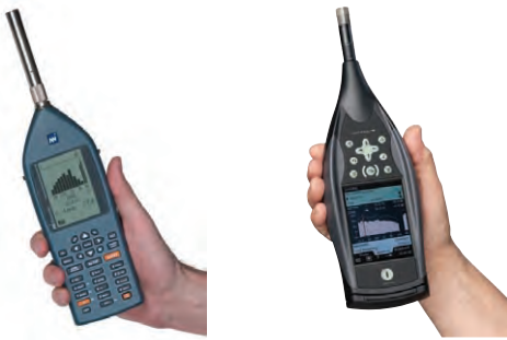
図24ー多機能のクラス1騒音計の近代的なデザイン。 Norsonic社のNor140型(ノルウェーのオスロ、左側)。 B&K社の2270型(デンマークのNaerum、右側)。
