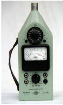
図13－B&Kの2203型騒音計（デンマーク製）。重量約3kg（1960年代）。直径25mmのコンデンサマイクロホン。表示盤上に対数的に目盛りが配置されている。時間の重み付けのFとSが選択できる。
