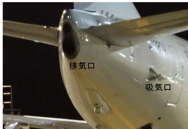
図-4 APUの排気口と吸気口(B737)
