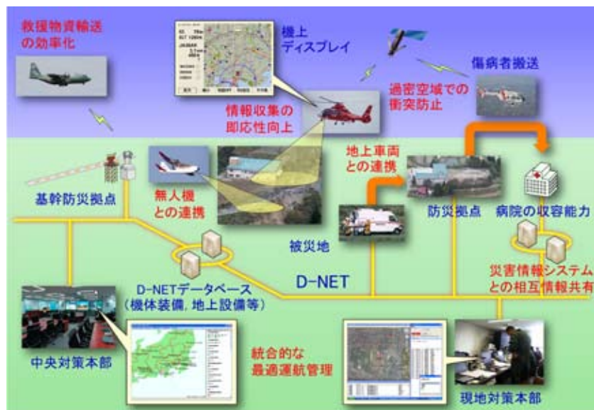
図-7 D-NET の概念図
