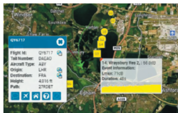
図2 騒音値と飛行経路の表示例 (ヒースロー空港Webtrakより)
