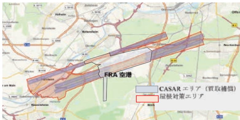
図6 後方乱流による屋根対策のためのエリア
