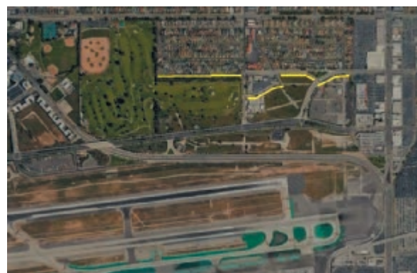
図5 空港北側の防音壁位置(黄色)
