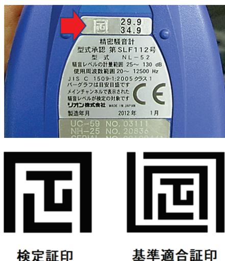
図19 騒音計の裏面に付された検定証印
