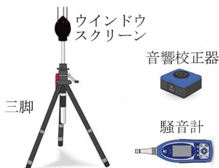
図1 航空機騒音の測定に用いる典型的な計測器
