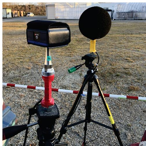
図18 音響校正器の使用例
