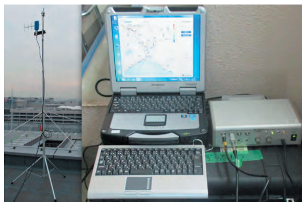
研究センターも開発にかかわった飛行経路観測装置(スカイゲイザー)による測定のようす
