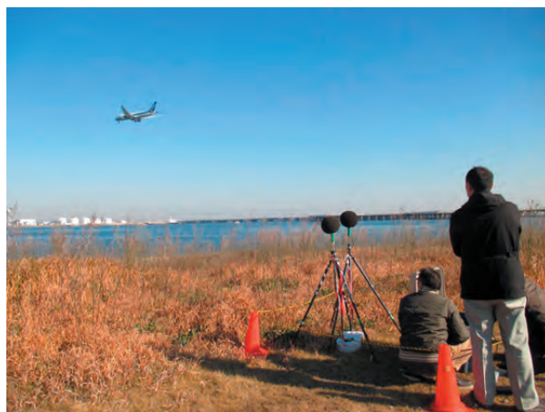
当時の航空機騒音測定の様子、測定者が航空機騒音を特定していた
