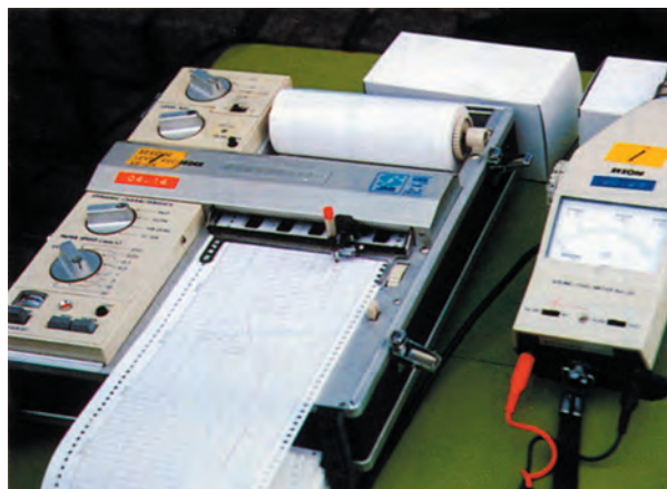
当時の航空機騒音測定機器、現在のようにメモリー記録ではなく、騒音計と記録計を接続し、記録紙に結果を出力していた
