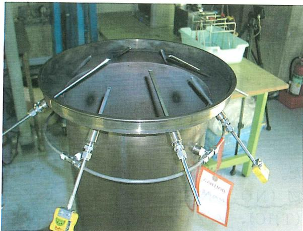
写真-1 排気ダクト (プローブ取付位置)
