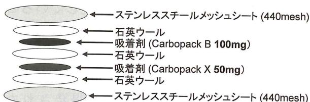
図-1 吸着ディスクの構成
