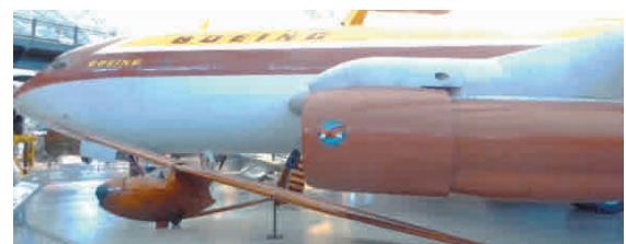
図7. ボーイング 707 の原型となった 367-80 バイパス比が低いためエンジンは細長い
