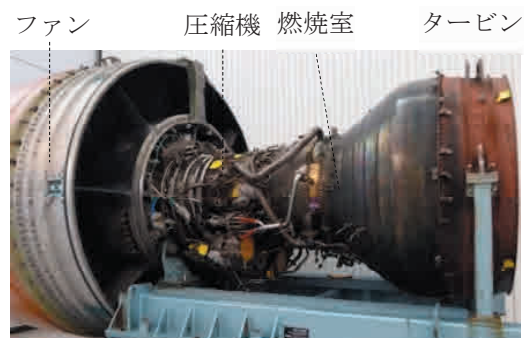
図4 ターボファンエンジン PW4090 の内部。 バイパス比が高く、前面ファンが大きい
